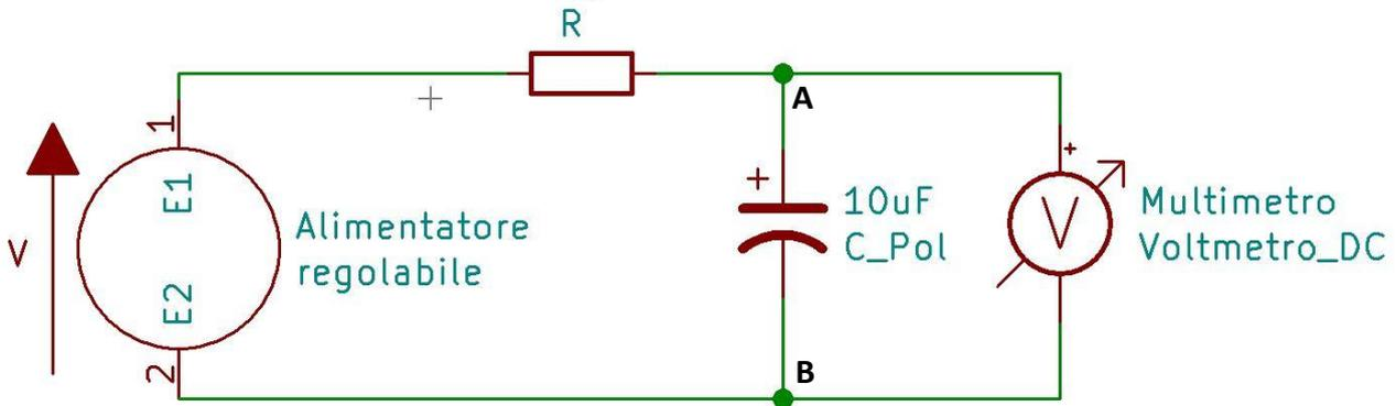
Dove il voltmetro ha una resistenza interna  $R_V=10\text{ Mohm}$ . Ci domandiamo quale resistenza vede il condensatore durante la carica? Qual è l'effetto della  $R_V$ ?
