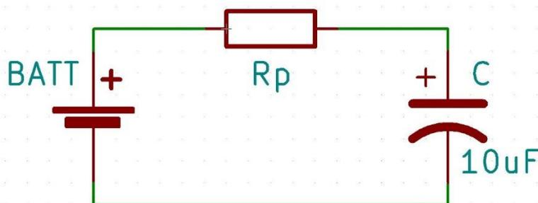
Dove  $R_p$  è il parallelo di  $R$  e  $R_V$ , e la batteria ha la tensione del nodo A nel partitore fra  $R$  e  $R_V$  del circuito precedente. Il risultato che da il parallelo delle due resistenze è evidentemente piuttosto contro intuitivo.
